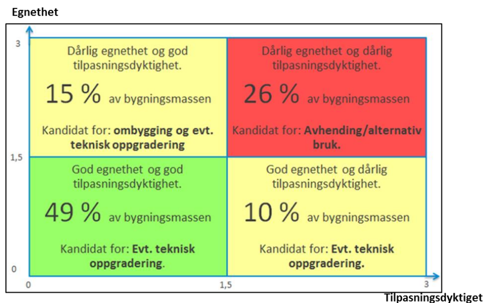
Figur 2-5: Bygningsmassen vurdert på egnethet og tilpasningsdyktighet (gjelder for 68 bygg)
